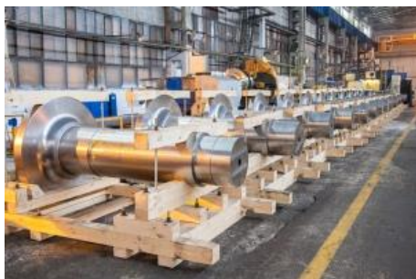
Рис. 59. «Энергомашспецсталь». Роторы для ветроэнергетических установок мощностью 1,5 МВт
