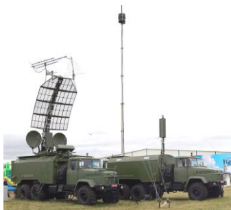
Рис. 67. Станция пассивного радиолокационного обнаружения и разведки «Кольчуга»
