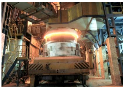
Рис. 53. «НКМЗ». Установка внепечной обработки стали «Ковш-печь»
